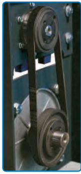
Trasmissione a cinghia Poly-V.
